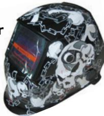
CELDA FOTOELÉCTRICA, SE CARGA AL SOLDAR NO REQUIERE BATERÍA. Variabilidad de oscurecimiento DIN9-DIN13 - 4 SENSORES, SOLDAR/ ESMERILAR
